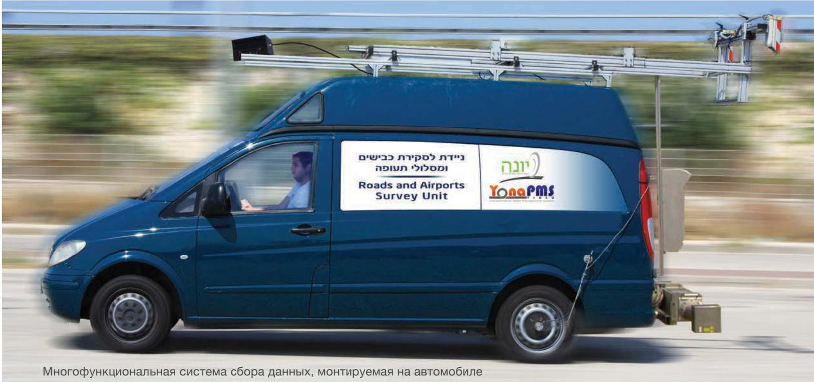
Многофункциональная система сбора данных, монтируемая на автомобиле
